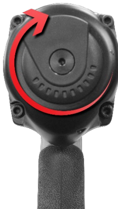
Figura 4: cómo ajustar el deflector de escape
